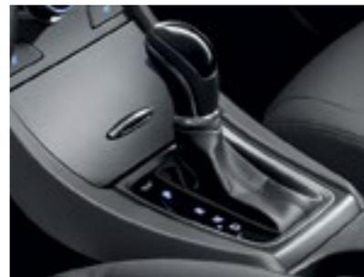
Изменение схемы переключения передач АКПП со ступенчатой на линейную позволяет водителю интуитивно совершать безошибочное переключение.
